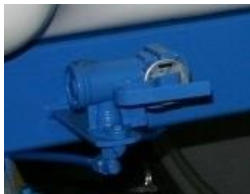
Regulator obciążenia dla hamulców 1-obwodowych.
