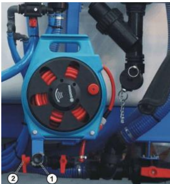
Rys. 9/1 Napelnianie zbiornika czystej wody za pomocą szybkozłącza
