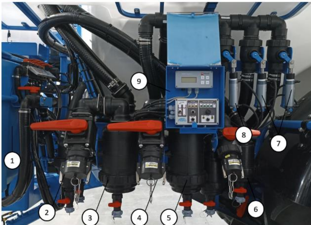
Rys. 6/2 Opis elementów obsługi strzykawkii GIGANT z pompą napełniającą
