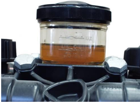
Rys. 16/7 Zbiornik wyrównawczy ze wskaźnikiem stanu napełnienia
