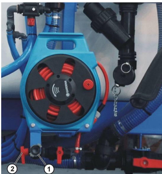
Rys. 9/3 Napełnianie zbiornika świeżej wody za pomocą szybkozłącza
