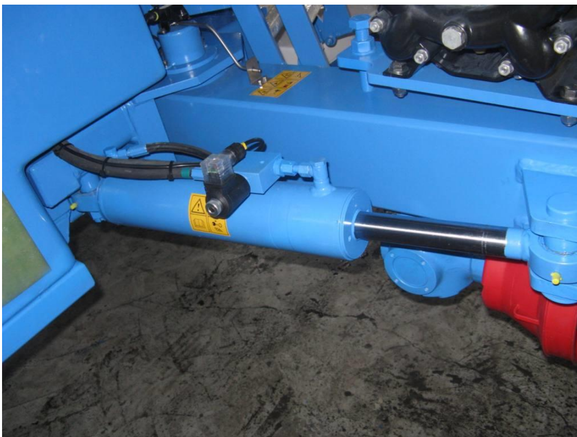
Rys. 15/3 Zabezpieczenie elektryczne wychylenia dyszla pociągowego
