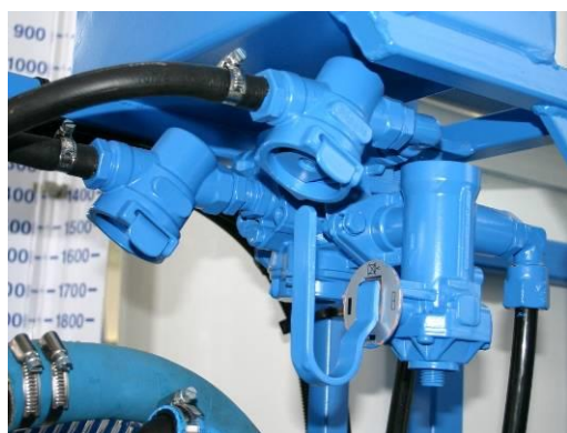
Regulator obciążenia hamulców 2-obwodowych.
